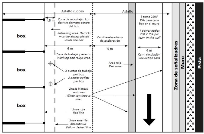
Pit-Lane (alzado) - elevation
